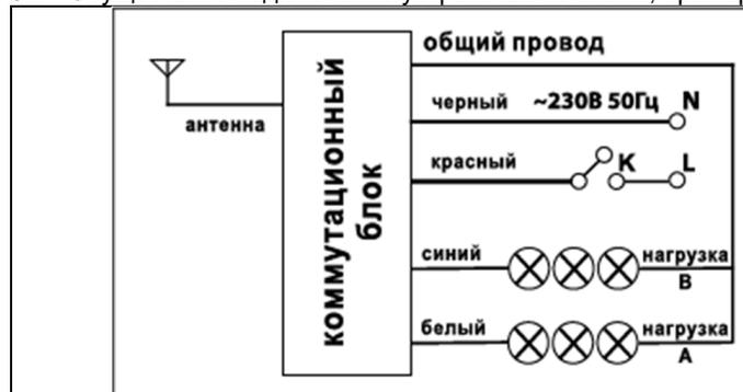
Рис. 1 Схема подключения ТМ72
